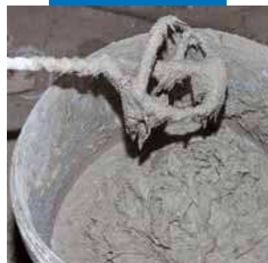
Miscelazione conclusa di Planitop HDM Restauro
